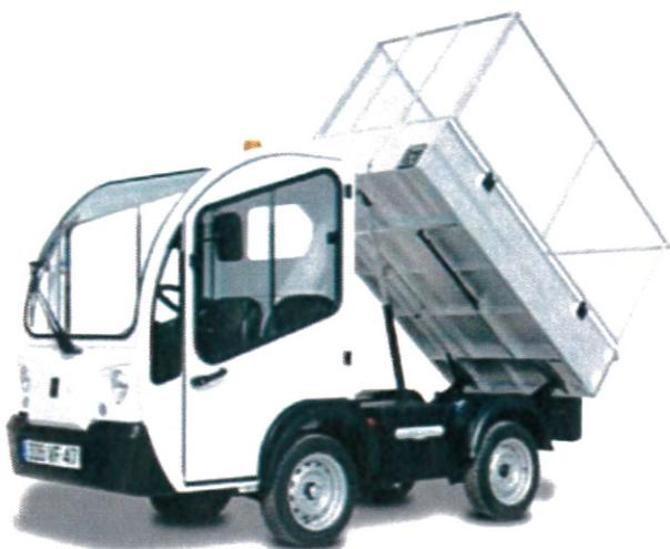
Équipé d'un plateau en aluminium qui bascule grâce à un vérin hydraulique, le G3 plateau basculant peut porter jusqu'à 700 kg sur le plateau. Avec ses rehausses grillagées (en option), il est l'outil de prédilection pour les services techniques, les espaces verts ou la propreté.
